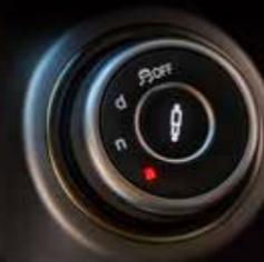
スポーツドライビング用のDモード、日常の運転に適したNモード、省燃費性能を重視したAモードと、条件に応じた最適な走りのスタイルを可能にします。
