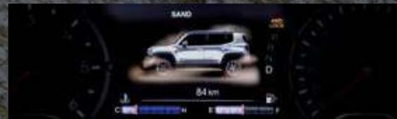
**SAND/MUD (砂/泥)** 電動4×4システムにより低速時のトルクとトラクションを向上。シャーシコントロール、ディファレンシャル、変速比を駆使することで砂地やぬかるみでの力強い走行を可能にします。
