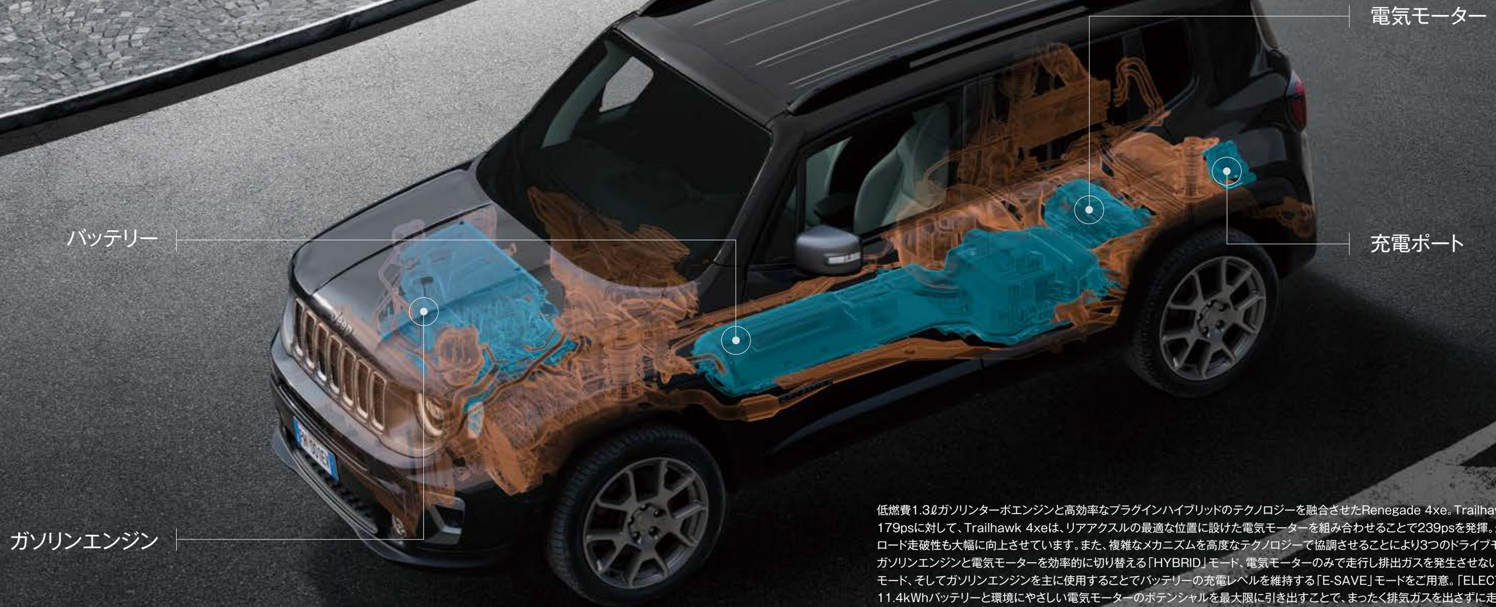
低燃費1.3ℓガソリンターボエンジンと高効率なプラグインハイブリッドのテクノロジーを融合させたRenegade 4xe。Trailhawkの最高出力179psに対して、Trailhawk 4xeは、リアアックスルの最適な位置に設けた電気モーターを組み合わせることで239psを発揮。最大トルクやオフロード走破性も大幅に向上させています。また、複雑なメカニズムを高度なテクノロジーで協調させることにより3つのドライブモードを設定。ガソリンエンジンと電気モーターを効率的に切り替える「HYBRID」モード、電気モーターのみで走行し排出ガスを発生させない「ELECTRIC」モード、そしてガソリンエンジンを主に使用することでバッテリーの充電レベルを維持する「E-SAVE」モードをご用意。「ELECTRIC」モードでは、11.4kWhバッテリーと環境にやさしい電気モーターのポテンシャルを最大限に引き出すことで、まったく排気ガスを出さずに走行距離48kmを実現。高速域でも十分パワフルな加速を味わえます。強さも優しさも手に入れた一台が、次世代のアーバンシーンを軽やかに駆け抜けます。
