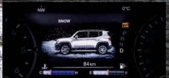
**SNOW (雪)** 雪道や凍結した路面で車両のスタビリティを最大限に高めながら、オーバーステアを最小限に抑えることで、雪道や凍結した路面で究極のパフォーマンスを実現。主要なシステムを制御してトルクフルな走りを実現します。
